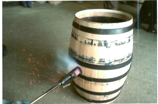
写真19 側面への穴あけ作業
