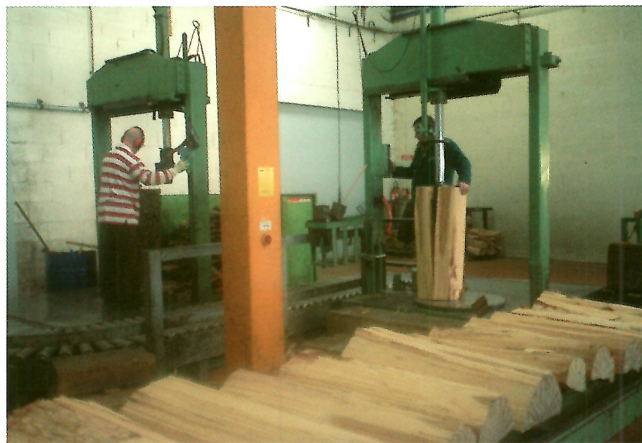
写真6 樹皮はぎと割りの工程
