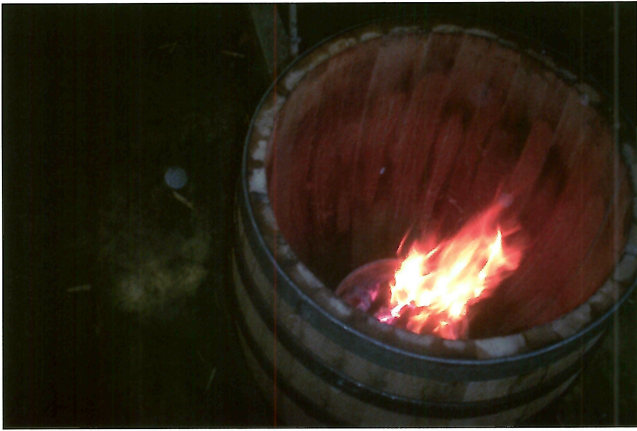
写真16 内面のトースティング工程
