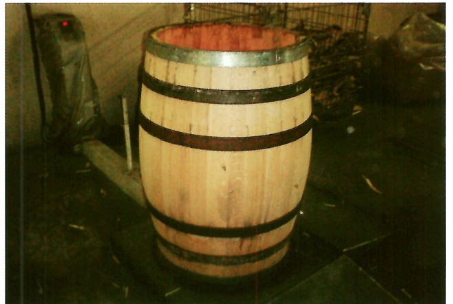
写真15 6本のフープがはめられて組み上がった樽
