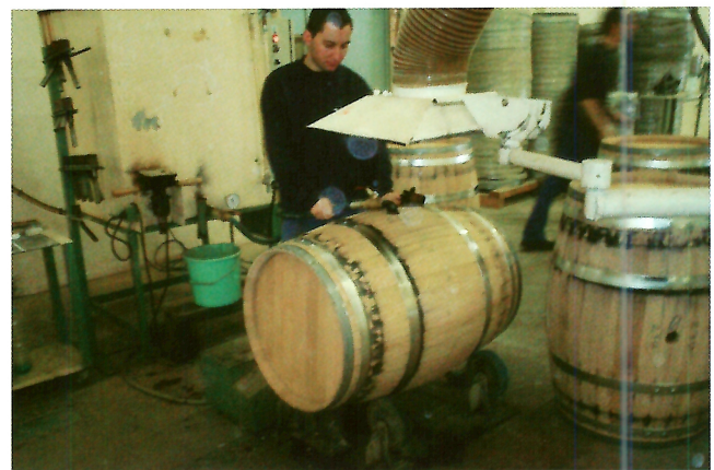
写真21 温水と加圧による漏れ試験
