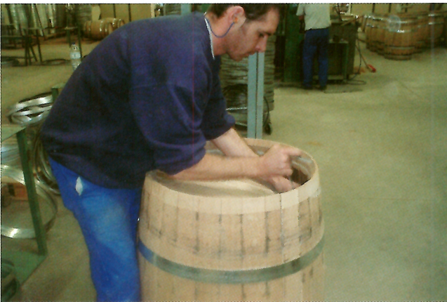
写真20 鏡板のはめ込み作業
