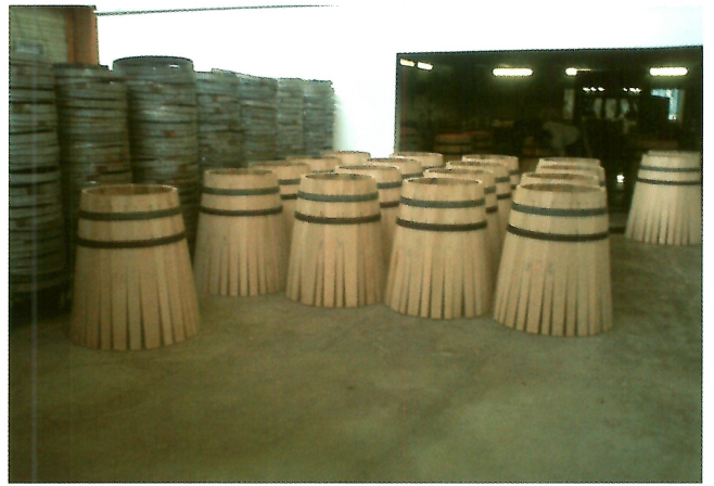
写真13 片側が組み上がった樽
