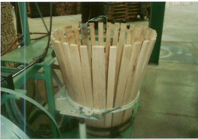
写真12 樽の形状へ組み立てられる樽板
