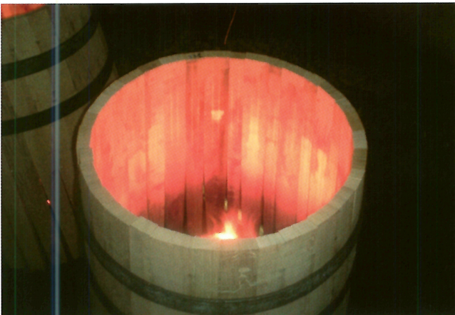
写真14 熱を加えて曲げ加工される樽
