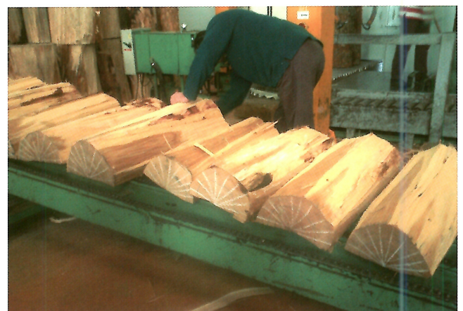
写真7 柁目の樽板を取るためのマーキング
